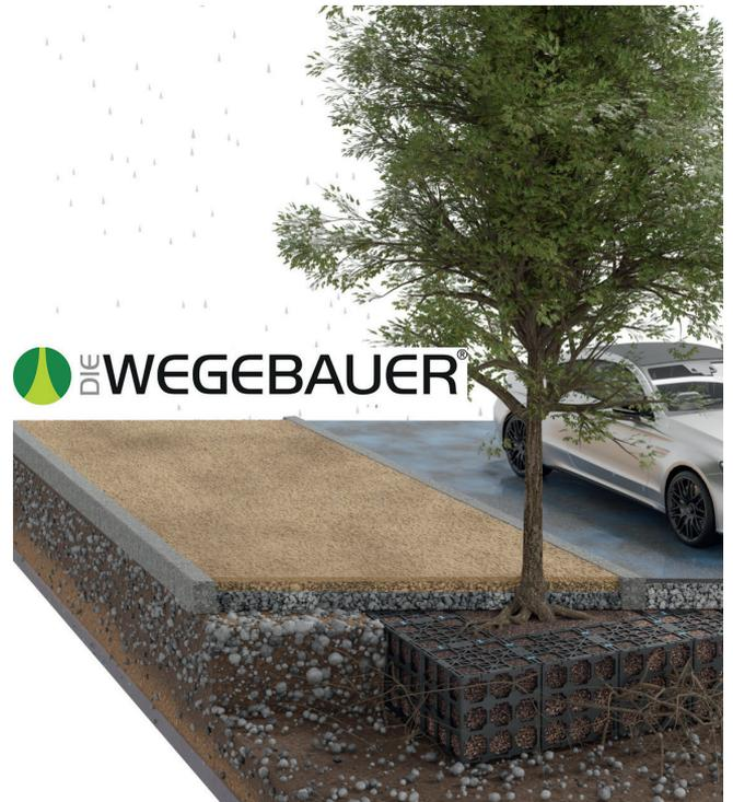
Aufbau einer Wassergebundene Wegedecke mit Sabalith® und Sabadyn® in Kombination mit dem ENREGIS/Treebox® System im Schnitt. | Bild: ENREGIS
